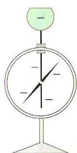
Slika 14: Elektroskop, ki smo mu približali ebonitno palico. [5, str. 58]
