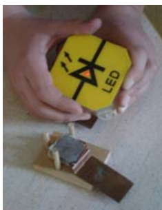
Slika 18: Pri členu, sestavljenem iz treh celic baker – cink, je dioda zasvetila.
