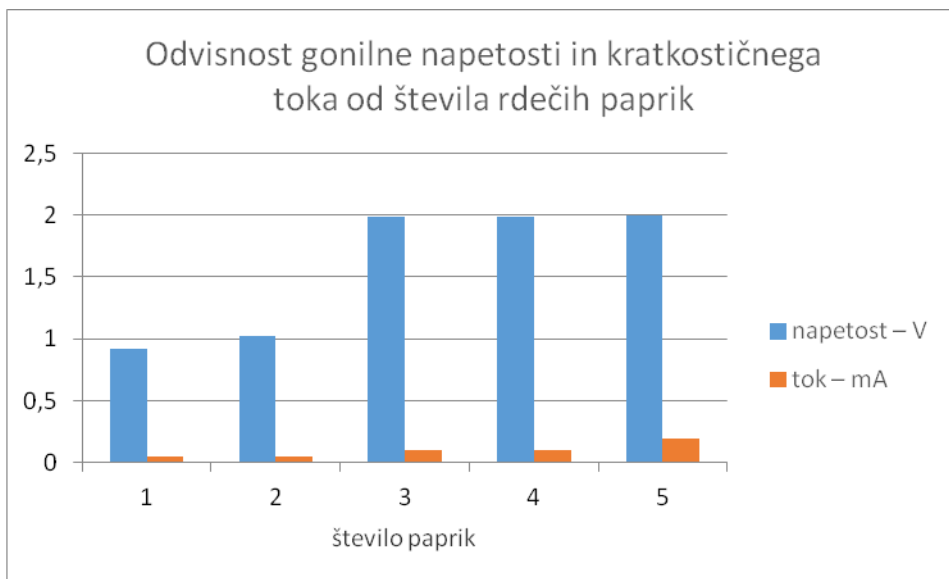
Graf 13: Odvisnost gonilne napetosti in kratkostičnega toka pri galvanski bateriji od števila paprik
