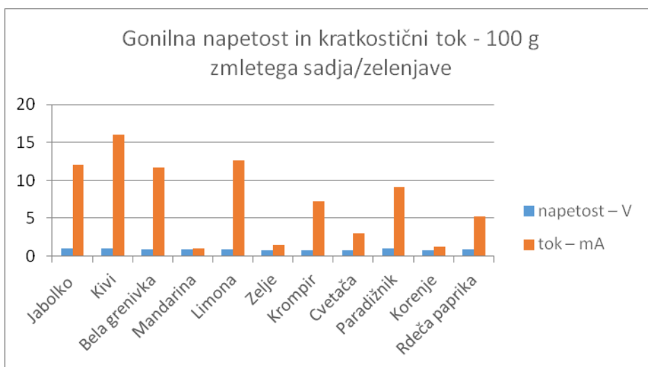
Graf 2: Gonilna napetost in kratkostični tok pri galvanskem členu iz 100 g zmletega sadja in zelenjave.
