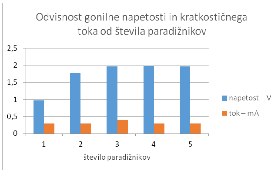
Graf 11: Odvisnost gonilne napetosti in kratkostičnega toka pri galvanski bateriji iz več paradižnikov
