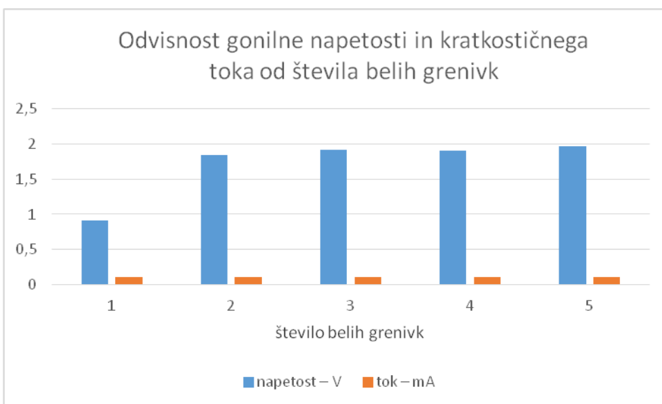
Graf 5: Odvisnost gonilne napetosti in kratkostičnega toka pri galvanski bateriji iz več belih grenivk
