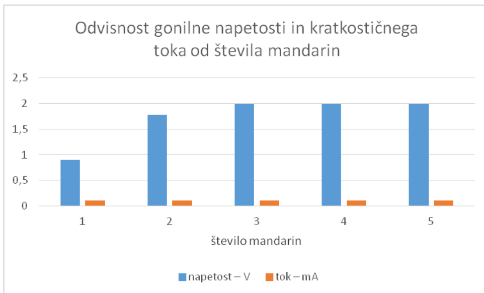
Graf 6: Odvisnost gonilne napetosti in kratkostičnega toka pri galvanski bateriji iz več mandarin
