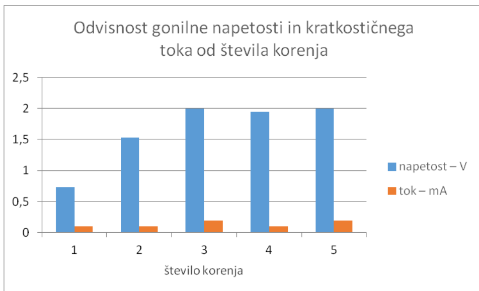
Graf 12: Odvisnost gonilne napetosti in kratkostičnega toka pri galvanski bateriji od števila korenja
