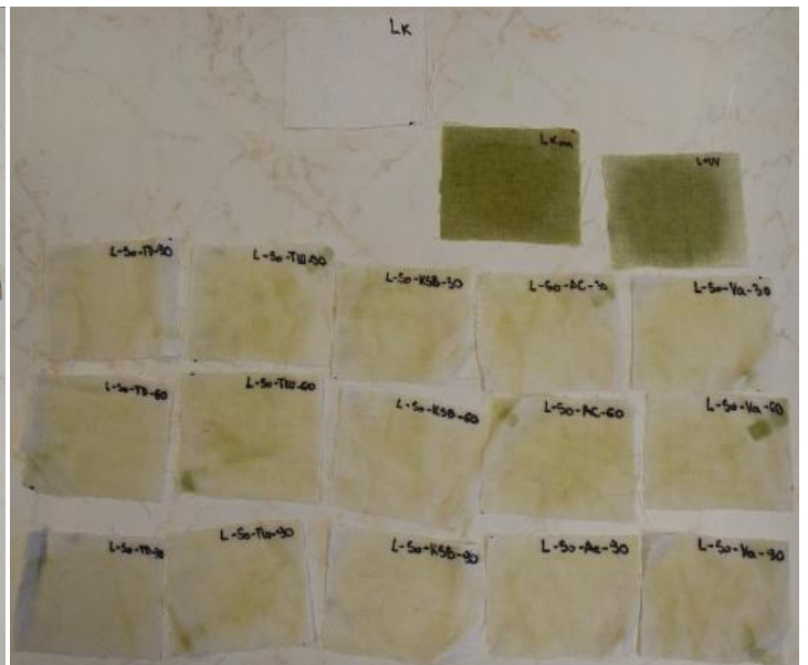
Slika 13: Madež od bučnega olja na lanu po 6 dneh na sončni svetlobi. (Vir: Detiček A., 2016)
