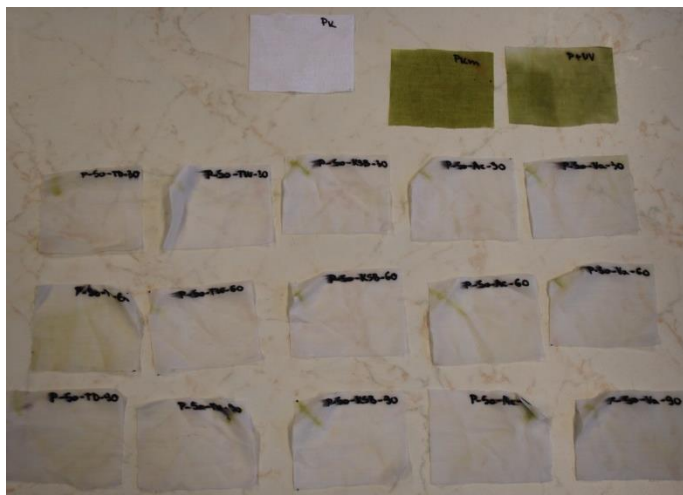
Slika 14: Madež od bučnega olja na platnu po 6 dneh na sončni svetlobi. (Vir: Detiček A., 2016)
