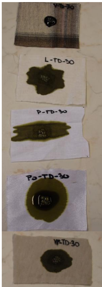
Slika 9: Vpicanje oljnega madeža na volni, lanu, platnu, poliesteru in viskozi-poliamidu. (Vir: Detiček A., 2016)
