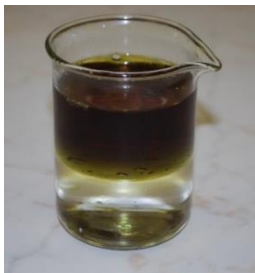
Slika 26: Zmes vode in raztopine čistilnega bencina z bučnim oljem. (Vir: Detiček A., 2016)
