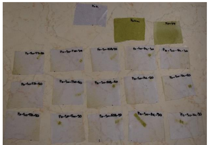
Slika 15: Madež od bučnega olja na poliestru po 6 dneh na sončni svetlobi. (Vir: Detiček A., 2016)
