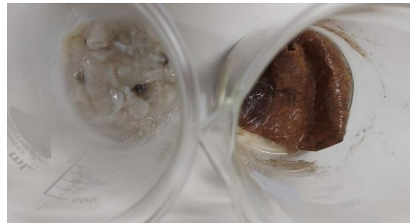
Slika 24: Bioplastika iz škroba (levo) in bioplastika iz bananinih olupkov (desno) v vodi po mešanju. (Avtor: Matevž Bračič, 2023)
